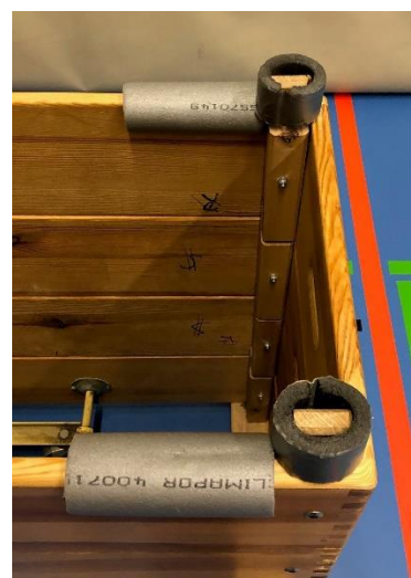
Abb. 4b: zwei offene Schutzteile für Stützen, längsgeschlitzte Teile für die Kanten
